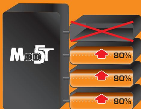
En cas d'arrêt de l'un des modules de puissance, les autres modules se répartissent la charge du module défaillant.
